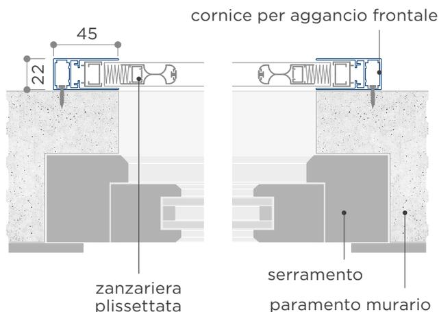
Estruso d'alluminio di fissaggio a muro per **zanzariere plissettate Plissé 22**.
