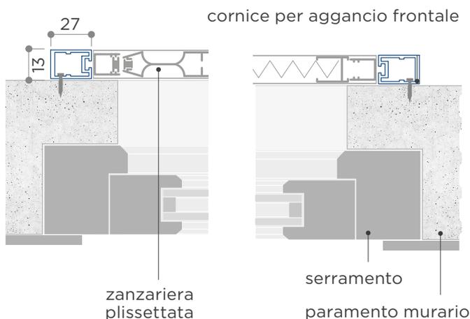
Estruso d'alluminio di fissaggio a muro per **zanzariere plissettate Plissé 13**.
